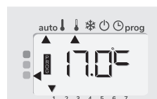
Fil pilote = Éco - 2 Confort - 2°C
