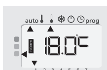
Fil pilote = Éco - 1 Confort - 1°C
