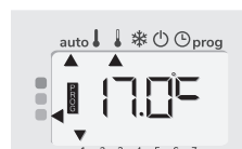
Fil pilote = Éco - 2 Confort - 2°C
