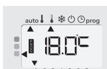
Fil pilote = Éco - 1 Confort - 1°C
