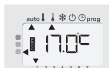
Fil pilote = Éco - 2 Confort - 2°C
