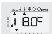
Fil pilote = Éco - 1 Confort - 1°C
