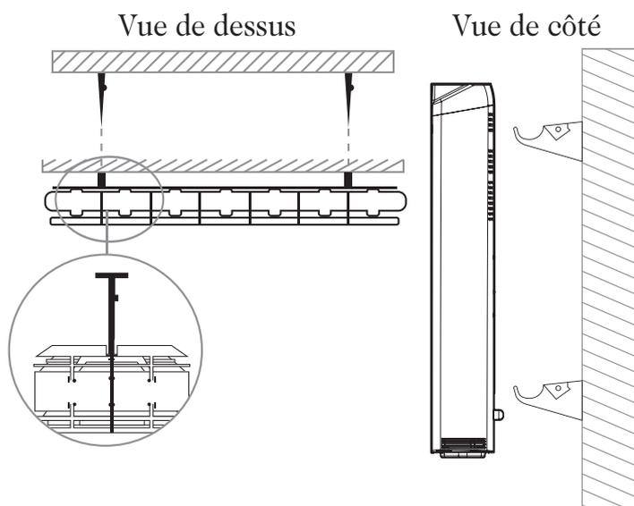
2-Posez le radiateur sur les pattes de fixation. A l'arrière du produit, veillez à ce que chaque patte de fixation s'incère entre les ailettes intermédiaires sans les altérer.
