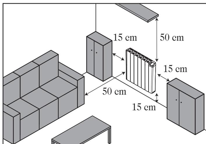
Installation préconisée dans le cadre d'une utilisation de la détection automatique d'ouverture de fenêtre.
