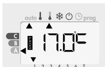
Fil pilote = Éco - 2 Confort - 2°C
