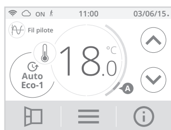
Fil pilote = Éco - 1 Confort - 1°C
