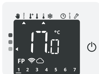
Fil pilote = Éco - 2 Confort - 2°C
